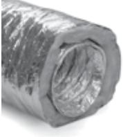
**Wkład ALUDUCT AD-L grubość izolacji 25 mm tem. od -20° do +120° płaszcz - folia poliestrowa paroszczelna - wewnętrznie perforowany ściśnięte do 1,2 mb (karton)**
